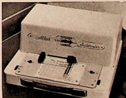
Audiometer „EM 42“, ein Hörschwellenmeßgerät
