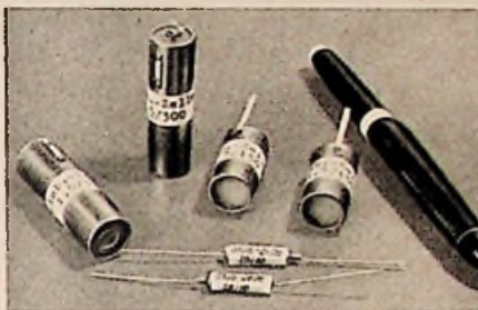
Stabilisationszellen für 1,5 V/300 mA (G. Neumann)
