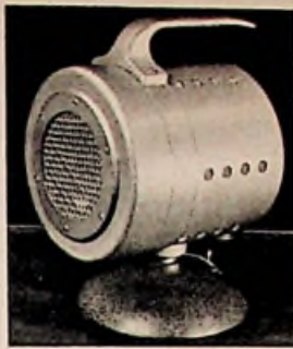
Links: Tonsirene für Mikrofonmessungen (G. Neumann). Oben: Kondensator-Kleinmikrofon „M 59“ mit Spezialröhre MSC 2 (A. Hiller KG.)
