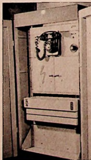
Abb. 2. Funksprechgerät der Bauart WG 20, eingebaut in den Werkzeugkasten einer Rangierlok
