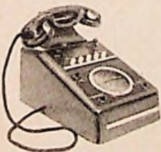
Abb. 9. Rangierfunksprechstelle für die Besprechung ortsfester Sende-Empfangs-Geräte
